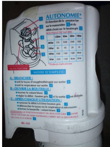
Figure 24: Exemple de tableau d'autonomie mentionné sur l'obus
