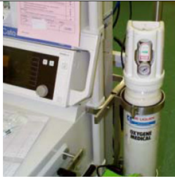
Figure 3: Exemple d'un obus de secours d'oxygène sur un respirateur
