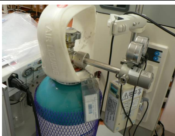
Figure 13: Détail du branchement du détendeur
